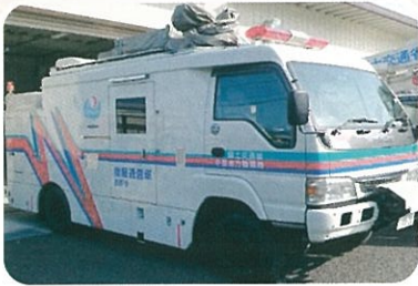
衛星通信車 (河川事務所)
